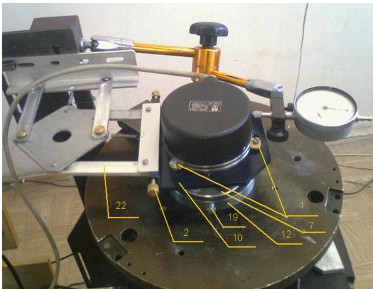
Рис. 9. Пример установки датчика ЛИР 190 на столе станка (вид 1) при выставке радиального биения.
